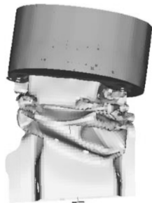
图10 优化后的落锤试验结果
