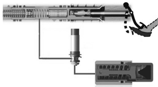
图4 IBC系统踏板感觉执行结构示意图
