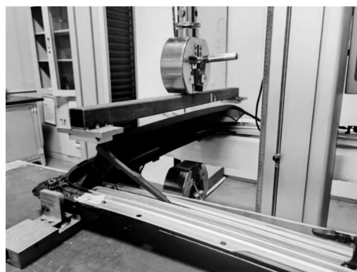
图7 扭转弹簧下压力测试装置
