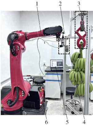
图 6 机器人智能化落梳试验平台
