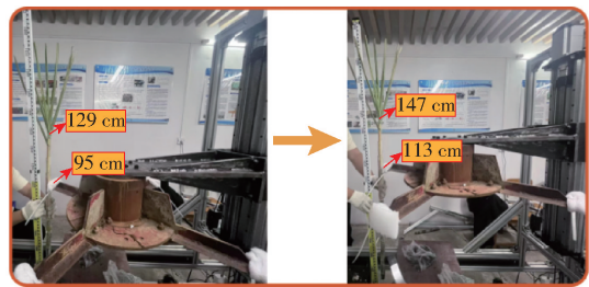
图 16 蔗梢高度变化及切梢器响应过程图
