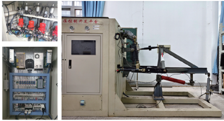
图2 耕深控制试验平台结构图
