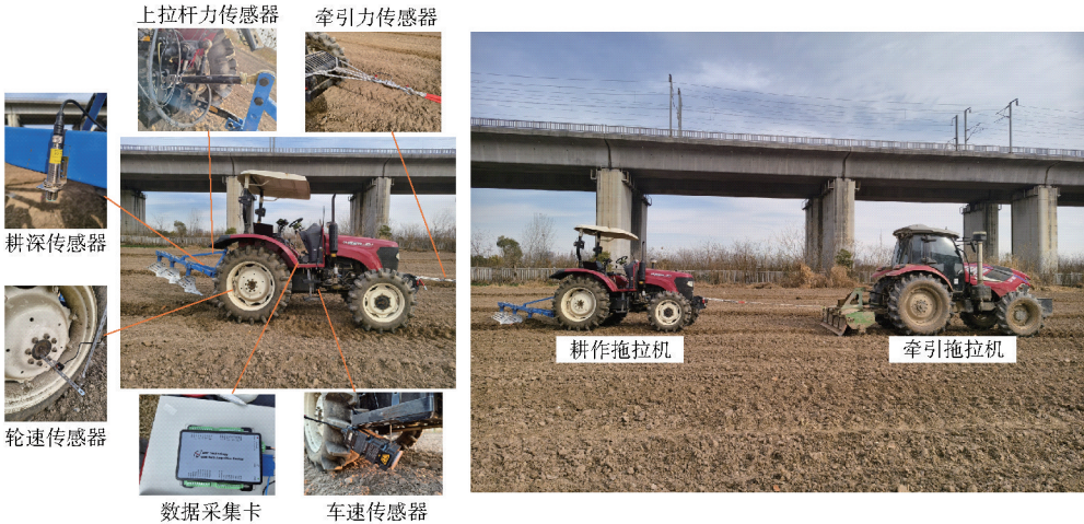
图 4 犁耕阻力田间测试平台
