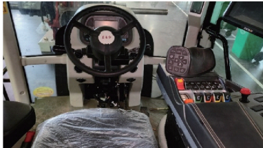
图 8 HQ2204 型氢燃料电池拖拉机驾驶室内部
