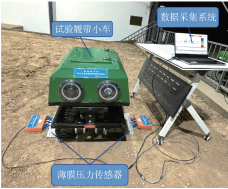
图 10 坡地接地压力试验
