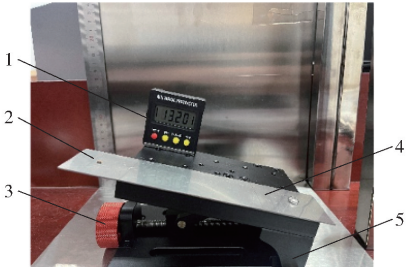
图 3 颗粒虾饲料与 304 号不锈钢之间摩擦因数斜面试验
