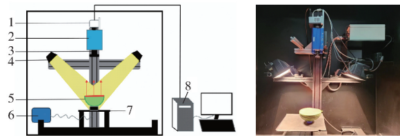
图2 高光谱信息采集系统原理图和实物图
