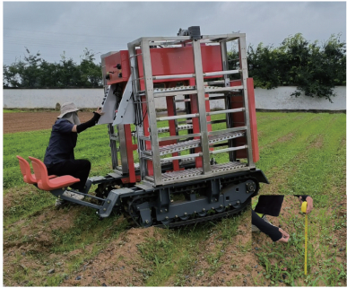
图 11 田间障碍通过性试验
