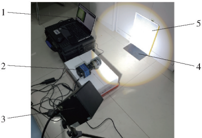
图 7 自由落体式碰撞恢复系数测定装置 Fig. 7 Free-fall collision recovery coefficient measuring device 1. 拍摄系统 2. 高速摄像机 3. 照明灯 4. 钢板 5. 背景刻度板
