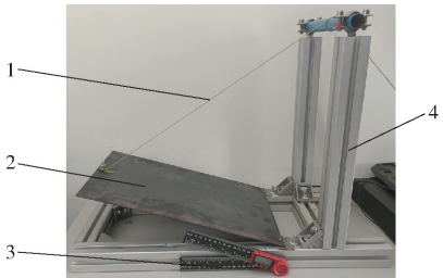
图3 自制斜面仪 Fig.3 Homemade inclinometer 1. 牵引绳 2. 钢板 3. 数显角度尺 4. 支架
