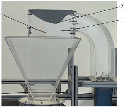
图 23 除杂系统试验台 Fig. 23 Impurity separation system test equipment 1. 引流板 2. 翼型曲面 3. 辅助板
