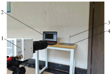
图 5 碰撞恢复系数测试装置
