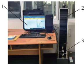
图 2 剪切模量测量试验装置
