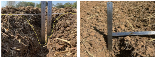
(a) 稻茬地耕深测定 (b) 稻茬地施肥深度测定
