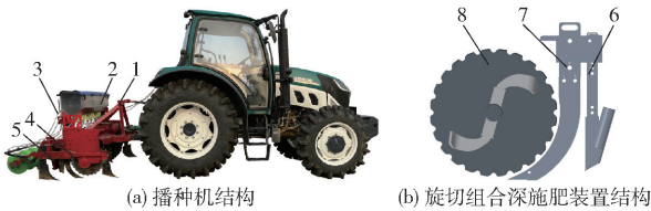
图 3 油菜播种机整机与旋切组合深施肥装置结构
