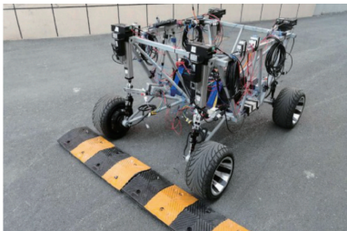
图 19 四轮腿式机器人平台
