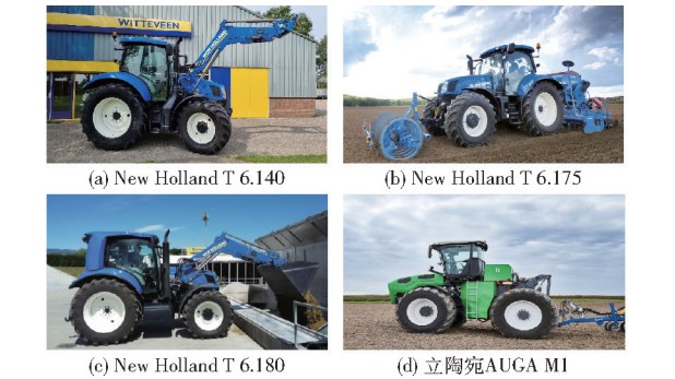
图 6 甲烷燃料动力拖拉机
