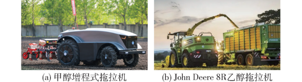
图 8 醇燃料动力拖拉机
