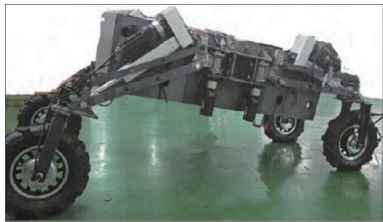
图 21 位姿自调节的轮腿式机器人平台
