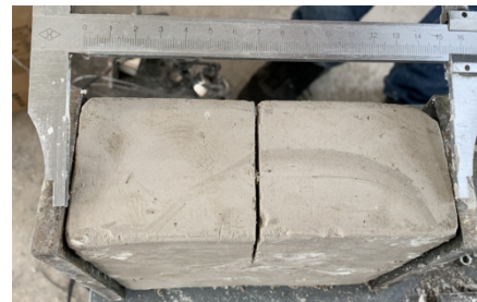
图9 初始裂缝试件 Fig.9 Initial crack specimen
