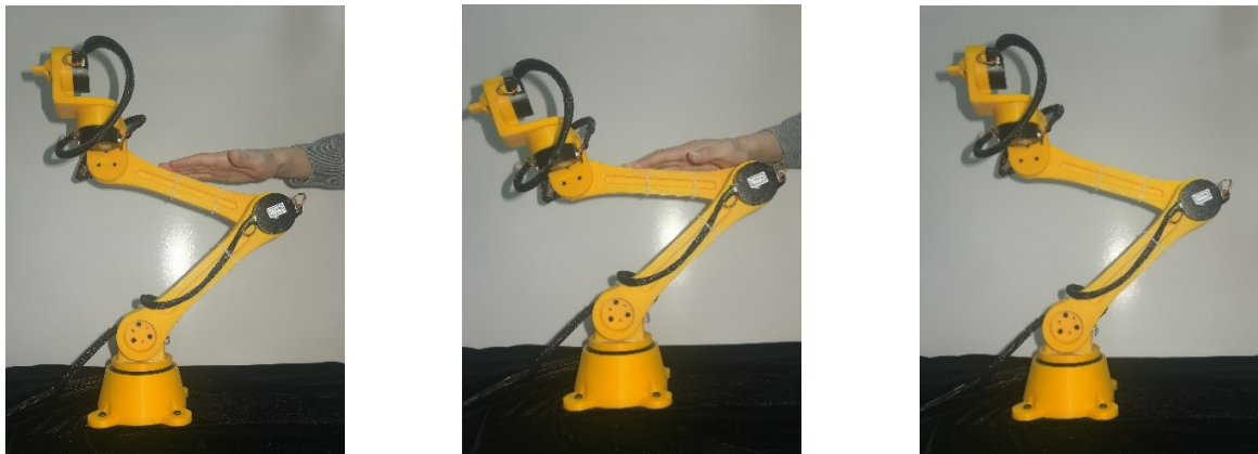
图 16 机械臂在外力下的柔顺响应
