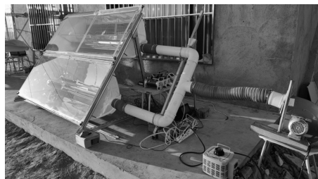
图4 复合抛物面聚光器性能测试实验系统
