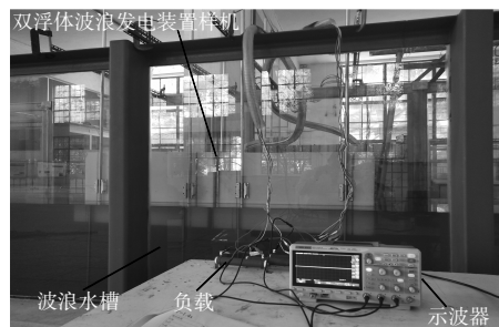
图 3 原型样机在波浪水槽试验图
