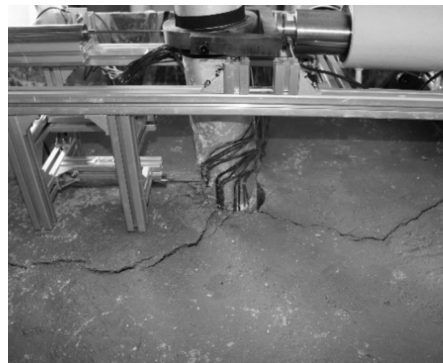
(b)桩左前方明显裂缝
