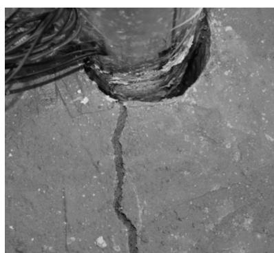
(c) 桩后方明显裂缝、脱开显著
