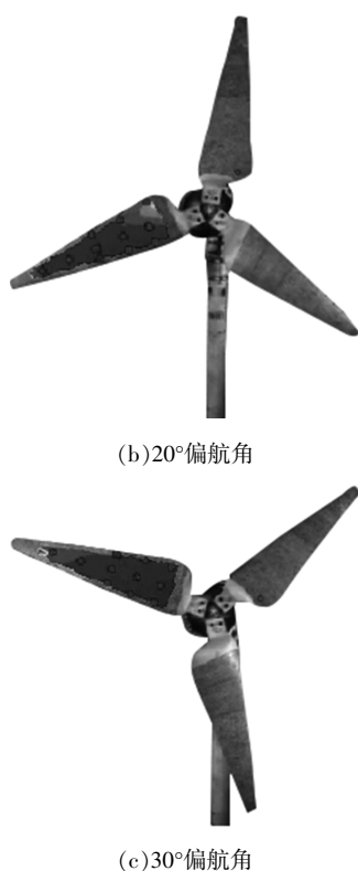
图5 风速为7 m/s、转速为400 r/min、不同偏航角下叶片动态挥舞变形最大值位置
