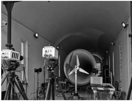
图1 风力机叶片动态挥舞变形测试系统
