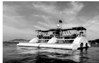
图 1 “万山号”鹰式波浪能发电装置
