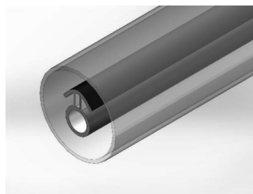
图 9 含二次聚光器的真空吸热管三维视图
