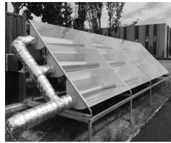
图 2 复合多曲面聚光集热器阵列
