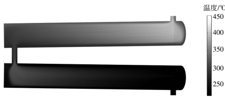
图 6 纵向截面内熔盐温度分布图
