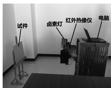
图 2 长脉冲红外热像试验装置
