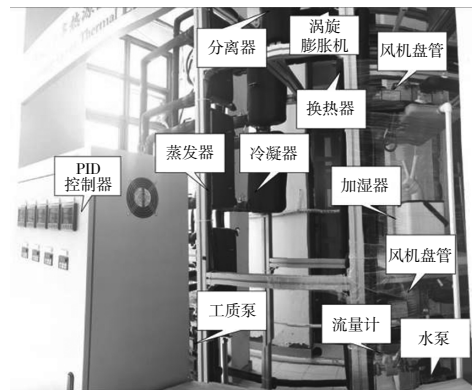
(a)OTEC-AC 系统试验布置图
