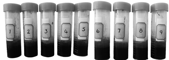
图 6 不同复合比例石墨烯/还原氧化石墨烯复合纳米流体静置 7 d
