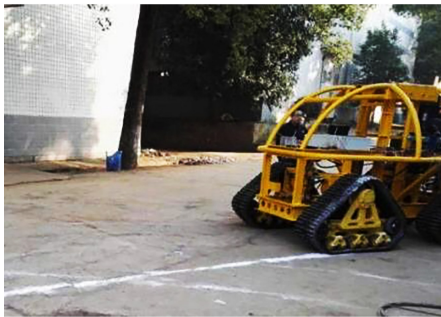
图14 四轮三角履带行驶机构转向试验
