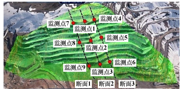
图 7 震后边坡位移监测点布置
