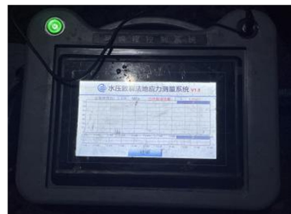
图1 地应力测量系统
