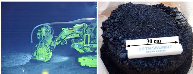
图3 水下无人机拍摄的采掘现场及采掘的富钴结壳
