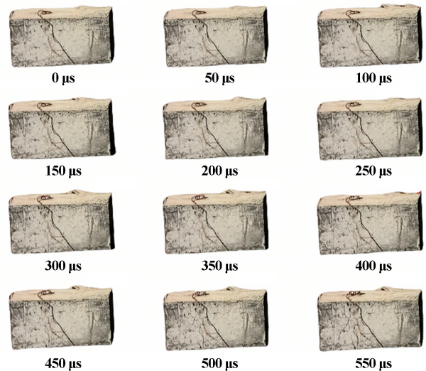
图4 对照组裂纹扩展过程
