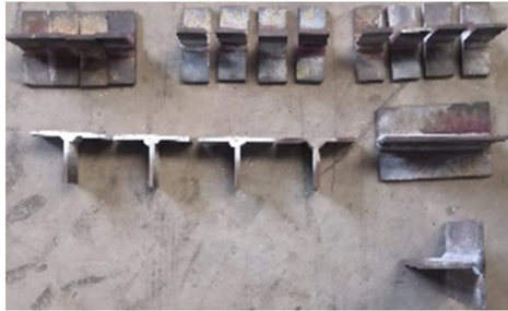
图5 T型接头焊接裂纹断面
