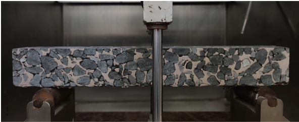
图 5 低温弯曲试验 Fig. 5 Low-temperature flexural test
