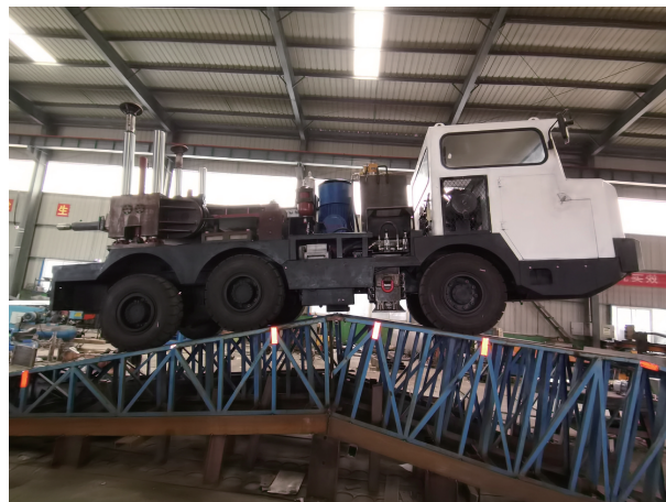
图8 胶轮车15°爬坡试验
