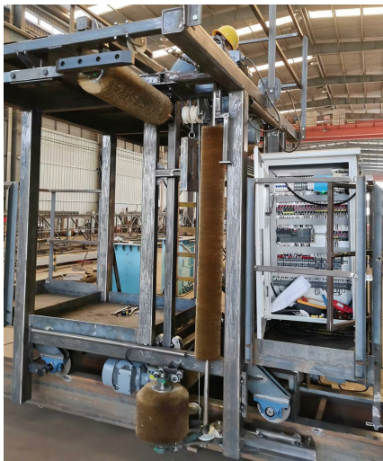
图2 打磨机器人主骨架实物图
