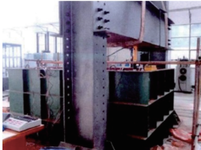
图2 桩端荷载下穿越溶洞室内模拟实验
