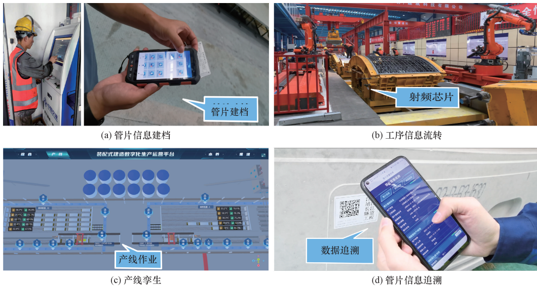
图 10 管片生产管理孪生 Fig. 10 Digital twin of pipe production management
