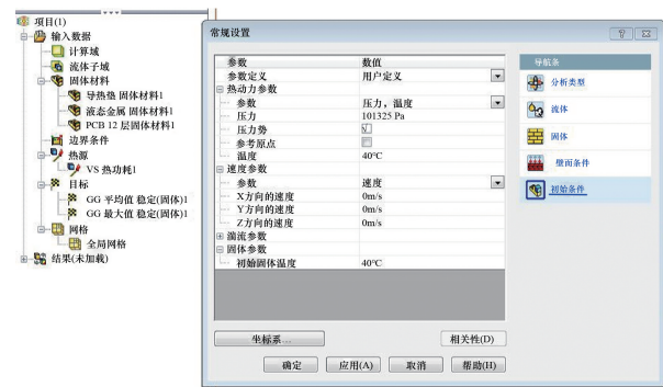
图 2 相变储能结构瞬态热仿真计算参数设置
