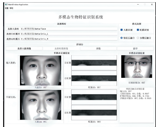
图10 特征层融合识别 Fig.10 Feature layer fusion recognition
