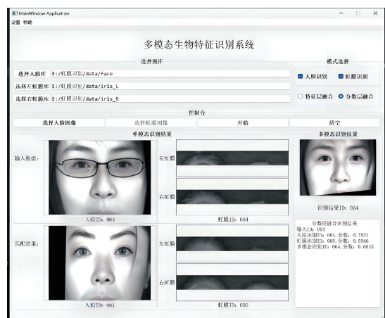
图11 分数层融合识别 Fig.11 Score layer fusion recognition
