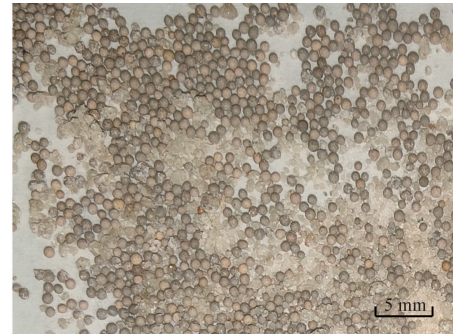
(a) 实验后岩板上脱落的支撑剂
