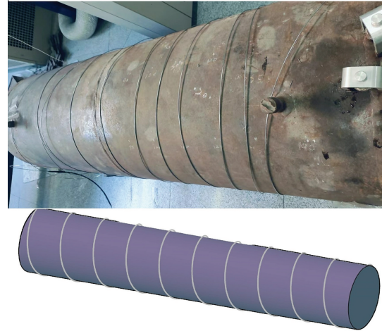
图 1 合成气管道模拟实验装置
