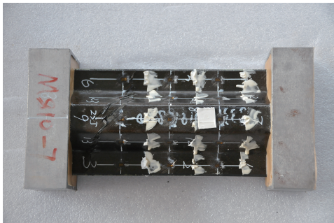
图5 试验件破坏图 Fig. 5 Failure mode of specimen
