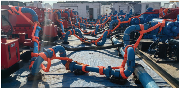
图 1 现场压裂支管布局图
