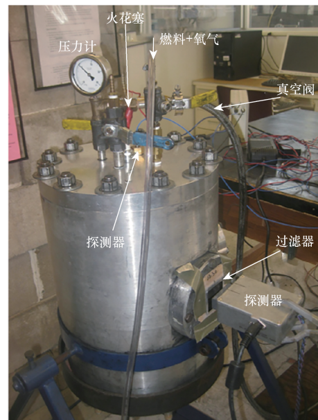
图2 立式圆柱爆炸罐实物图 [28]
