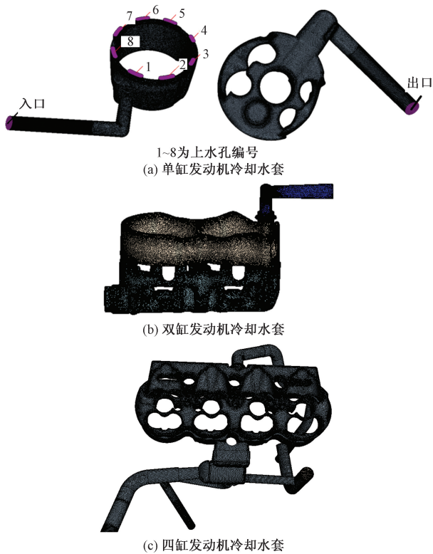
图4 摩托车发动机冷却水套网格模型
