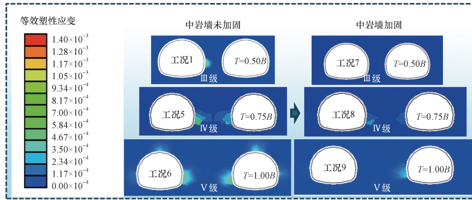
图 11 中岩墙注浆加固前后围岩塑性区分布规律
